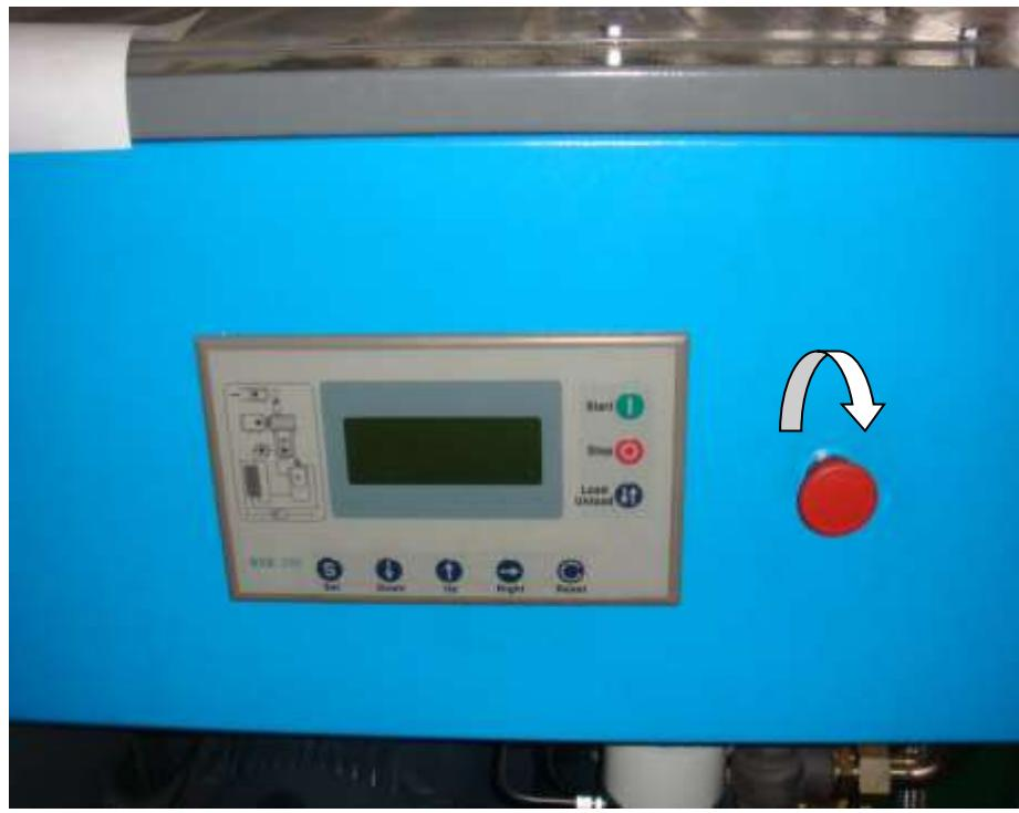
Кнопка аварийной остановки системы. Для экстренного выключения компрессора- нажать. Для возвращения в нормальный режим работы поверните кнопку по часовой стрелке.
